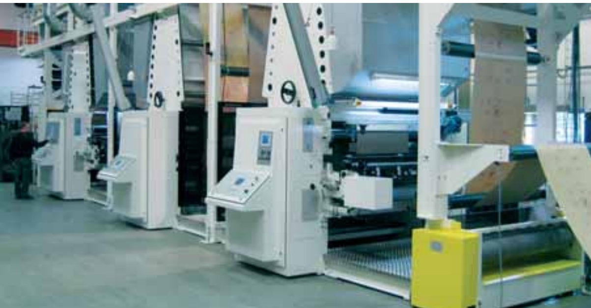
Die Flexodruckmaschine der TRESU Group bedruckt Papier für Verpackungsmaterial.
