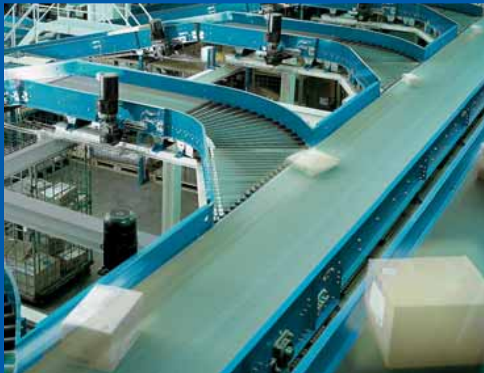
Système de convoyage intégrant le convertisseur de fréquence 8200 vector de Lenze. Celui-ci communique avec le système maître via INTERBUS.
