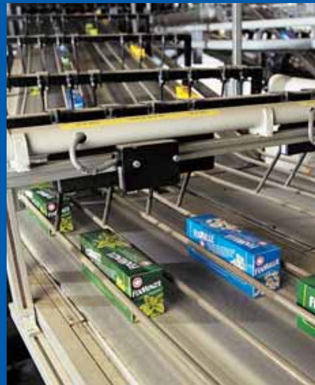
Machine d'emballage intégrant des convertisseurs de fréquence 8200 vector de Lenze. La communication s'effectue via PROFIBUS-DP.
