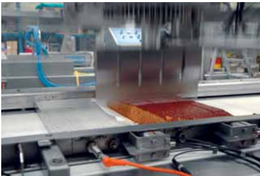
Der Clou ist Ultraschall: Er lässt das Messer mit 20.000 Schwingungen pro Sekunde vibrieren.
