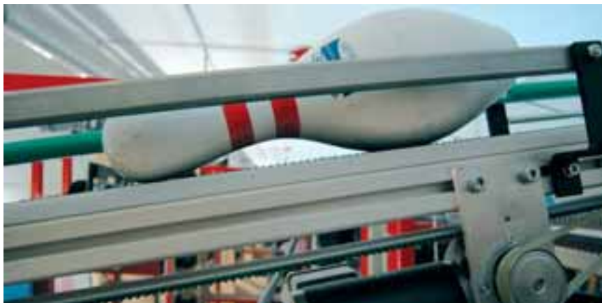
Ein SDS-Motor, kombiniert mit einem Schneckengetriebe, transportiert einen Pin zum Verteilerteller.
